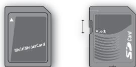
*Le schede di memoria MultiMedia (MMC) e Secure Digital (SD) sono reperibili presso molti rivenditori. Le schede prodotte da SanDisk sono testate e approvate per essere utilizzate con BeoSound 2. Per proteggere una scheda SD da scrittura, abbassare il dispositivo di scorrimento.*
