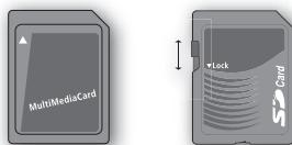
*MultiMedia- (MMC) und Secure Digital- (SD) Karten sind von mehreren Herstellern erhältlich. Speicherkarten von SanDisk wurden getestet und sind zur Benutzung im BeoSound 2 empfohlen. Sie können den Schreibschutz für eine SD-Karte aktivieren, indem Sie den Schieber nach unten drücken.*
