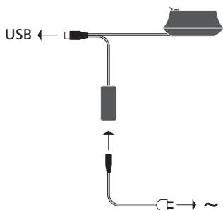
Schließen Sie das USB-Kabel an – warten Sie bei einem PC, bis Sie hierzu aufgefordert werden.
