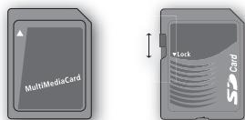
*Les cartes mémoire MultiMedia (MMC) et Secure Digital (SD) se trouvent aisément dans le commerce. Les cartes fournies par SanDisk sont testées et agréées pour une utilisation avec le BeoSound 2. La carte SD est dotée d'une glissière permettant de la verrouiller en écriture (position basse).*
